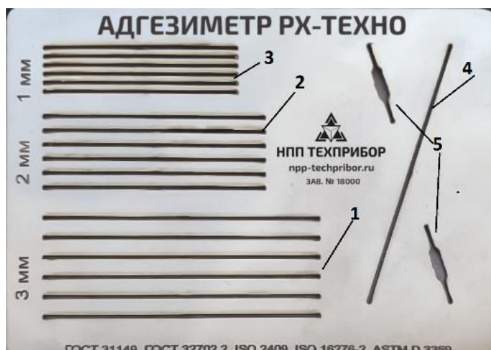
Рисунок 1– Адгезиметр надрезов РХ-ТЕХНО: 1 – прорези с шагом 3 мм; 2 – прорези с шагом 2 мм; 3 – прорези с шагом 1 мм; 4 – основная прорезь X-метода; 5 – ромбовидные окна
